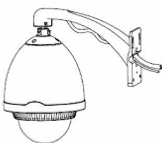
1. Проденьте кабель в отверстие кронштейна
